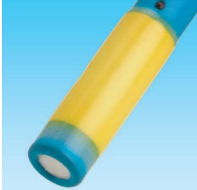
Die Bezugs elektrode ist, getrennt von der Messelektrode, im Kopfteil der Sonde integriert. Die Elektrolytverbindung zwischen dem Elektrolytgefäß, der Bezugs elektrode und dem zu messenden Produkt wird über einen Schlauch mit Schnellkupplung und ein eingeschrumpftes, aseptisches Schliffdiaphragma hergestellt.
