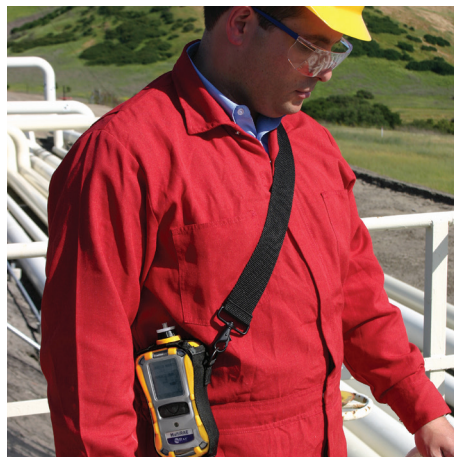
MultiRAE wird für die Expositionsüberwachung am Arbeitsplatz in einer Ö Raffinerie verwendet
