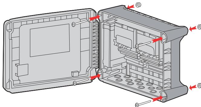
Touchpoint Plus wird mit 13 vorgebohrten und abgedichteten Kabelzugängen für Kabelzuführungen vom Typ PG16/M20 bereitgestellt.
